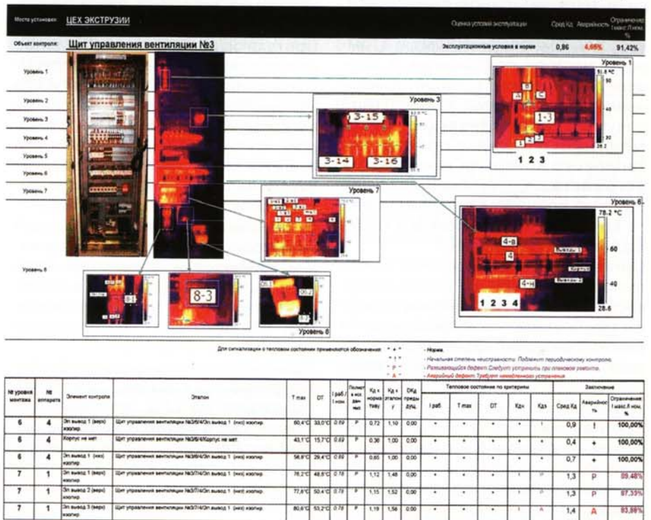
Рис. 2. Ведомость тепловизионного наблюдения за техническим состоянием электрооборудования.
