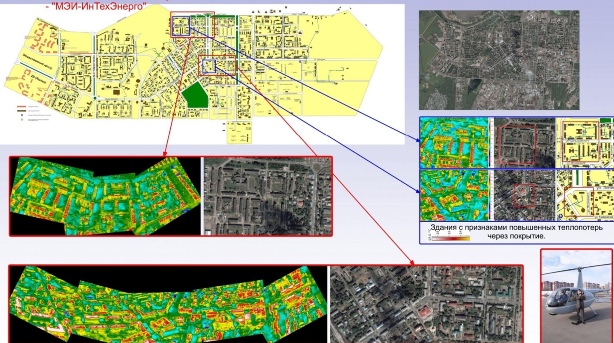
Рис. 11. Данные «экспресс-аудита» с использованием тепловизионной съемки с вертолета позволяют определить «болевые точки» и затем целенаправленно проводить энергоаудит этих объектов
