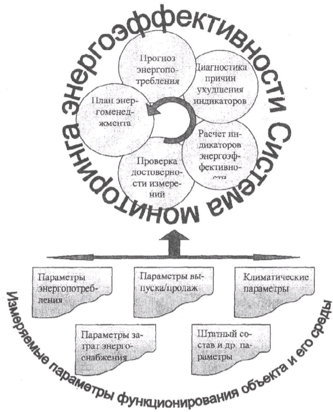
Рис. 3. Цикл мониторинга энергоэффективности
