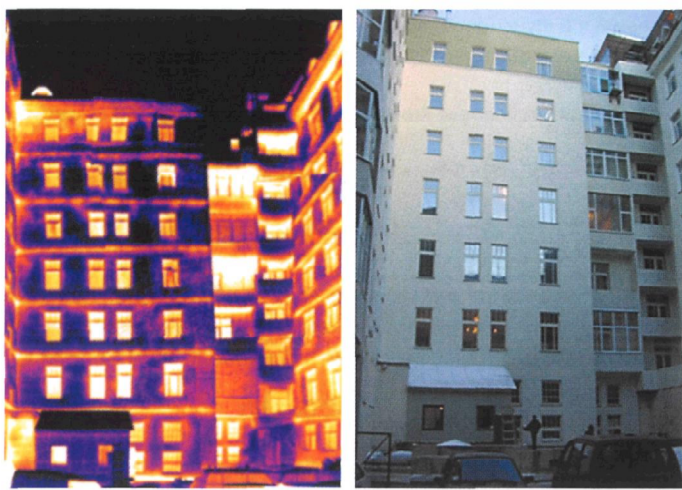
Определение сопротивления теплопередаче стен и светопрозрачных конструкций
