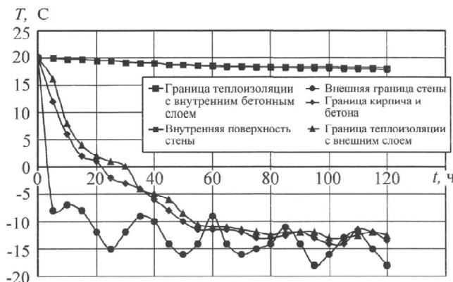
Рис. 2. Изменение во времени температуры на слоях стены
