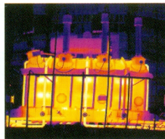
Рис. 3. Термограмма поверхности мощного силового трансформатора с существенными отклонениями по температуре на левой фазе.
